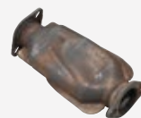
CAT. DANIFICADO POR IMPACTO Impacto sob o veículo que danificou o catalisador
