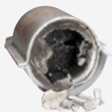
CATALISADOR DERRETIDO Sobreaquecimento
