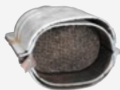
CATALISADOR OBSTRUÍDO Combustão incompleta por contaminação de aditivos
