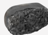
DAÑO POR EXCESO DE ACEITE Por entrada de aceite en el sistema de escape
