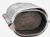
CATALIZADOR OBSTRUIDO Combustión incompleta por contaminación de aditivos
