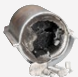
CATALIZADOR DERRETIDO Sobrecalentamiento
