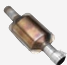
CATALIZADOR QUEMADO Temperatura de escape demasiado elevada
