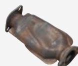
CAT. DAÑADO POR IMPACTO Impacto en el vehículo que dañó al catalizador
